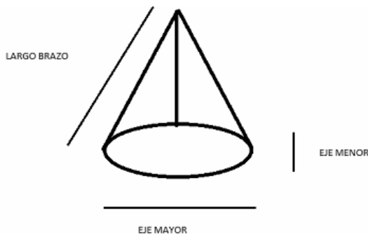
Figura C3. Componentes del dispositivo excluidor de peces tipo “ojo de pescado”.
